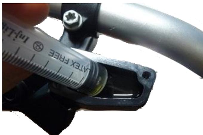
9. Versare olio DOT4 nuovo prelevato da un contenitore sigillato all'interno del serbatoio sulla pompa freno
