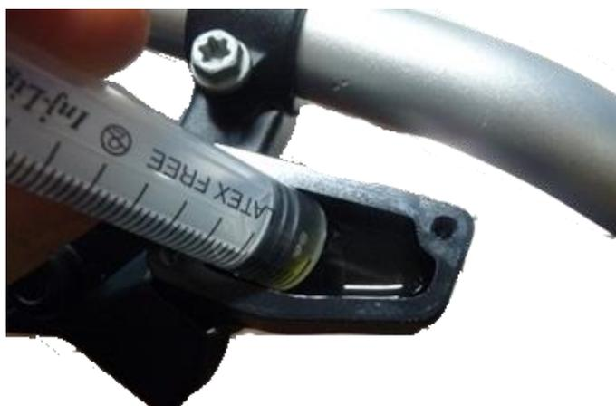
7. Premere la siringa lato pinza finché l'olio raggiunge metà altezza del serbatoio della pompa freno.
