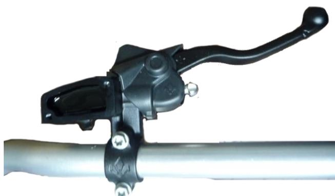
12. Riposizionare la membrana (11) all'interno del serbatoio sulla pompa. Serrare il tappo (10) con le due viti (9) utilizzando una chiave dinamometrica con inserto Torx TX20 con coppia di serraggio  $1.25 \pm 0.25$  Nm.
