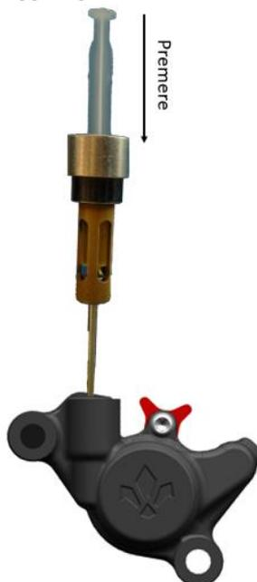
8. Rimuovere l'olio vecchio presente nel serbatoio della pompa con una siringa.
